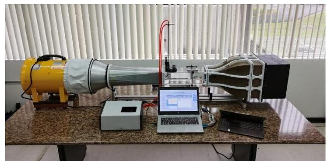
**Figura 2.** Túnel de viento puesto en operación en el LACOMET.
