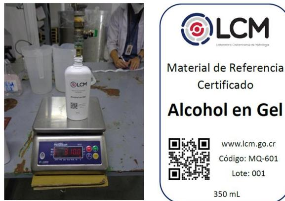
**Figura 3.** Envasado por peso del MQ-601 y etiqueta utilizada.
