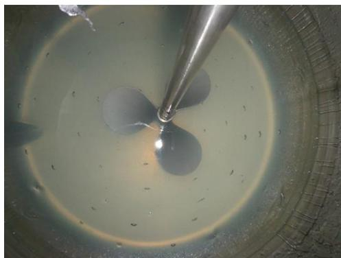
**Figura 2.** Agitador de aspas utilizado para homogeneizar el MQ-601.
