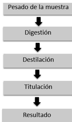
**Figura 1.** Diagrama de flujo de la determinación del contenido de proteína en leche en polvo.
